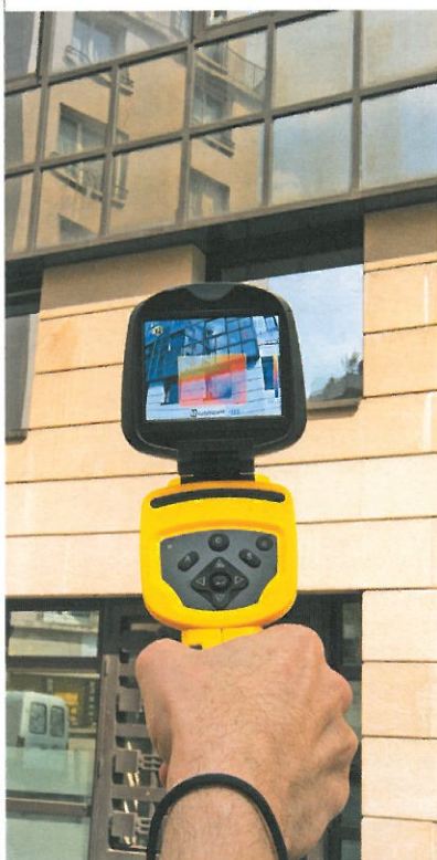
► Une caméra infrarouge permet de visualiser très concrètement les défauts d'isolation (ici, caméra Chauvin-Arnoux).
